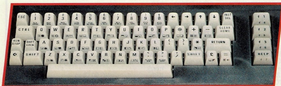
Bild 2. Die Tastatur ist bewährt und gut. Deutlich erkennbar ist die gegenüber dem VC 20 geänderte Belegung einiger Tasten.
