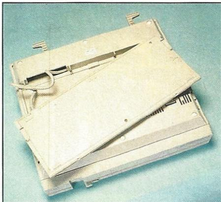
Bild 4. Die Tastatur läßt sich bequem an der Unterseite des C 128 D verstauen
