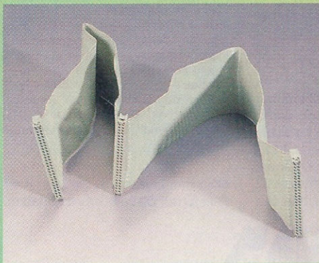
[5] Zum Anschluß der zweiten Platte brauchen Sie ein 50poliges Flachbandkabel mit zwei Anschlußsteckern auf der einen Seite (für die Laufwerke) und einem auf der anderen (für den Hard-disk-Controller).
