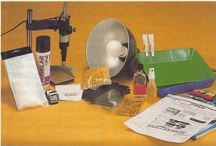
1 Das ist die erforderliche Grundausrüstung zur Platinenherstellung
