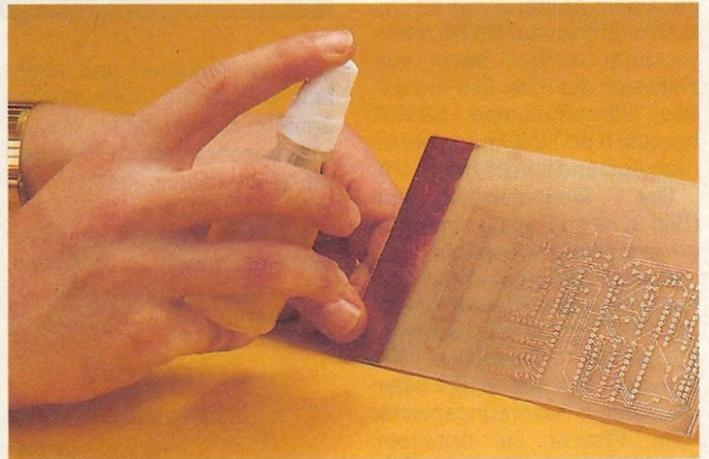
**8** Ist die Platine fertig gebohrt, sollte man sie zum Schutz mit Lötack einsprühen
