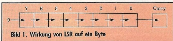
Bild 1. Wirkung von LSR auf ein Byte
