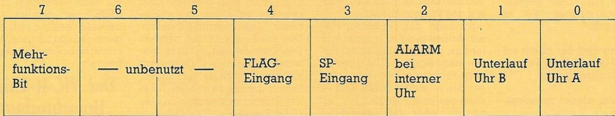
Bild 5. Genereller Aufbau der Unterbrechungs-Kontroll-Register (13) der beiden CIA-Bausteine
